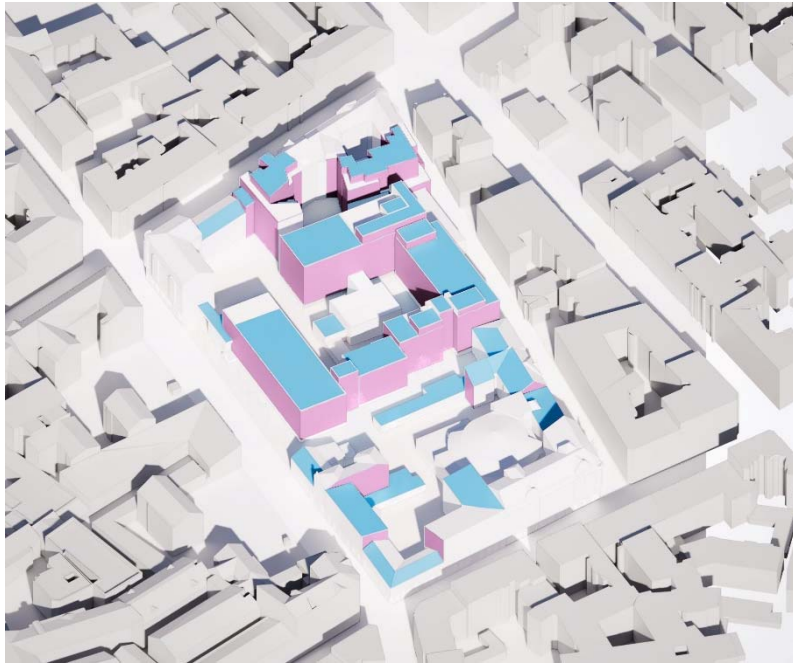
6.4. att. AER tehnoloģiju izvietošana uz ēku jumtiem (zils – PVT, PV napeļi, violets – BiPV paneļi)
