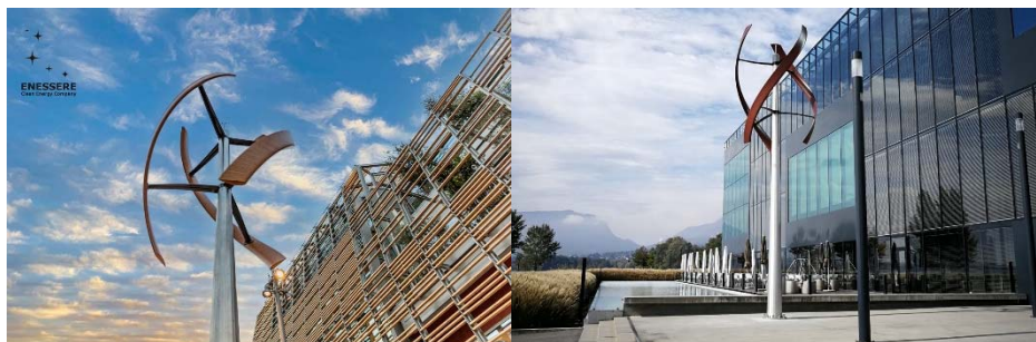
4.14.att “Enesserre Hercules” mazā vēja turbīna izmantošanai pilsētas teritorijā [122]
