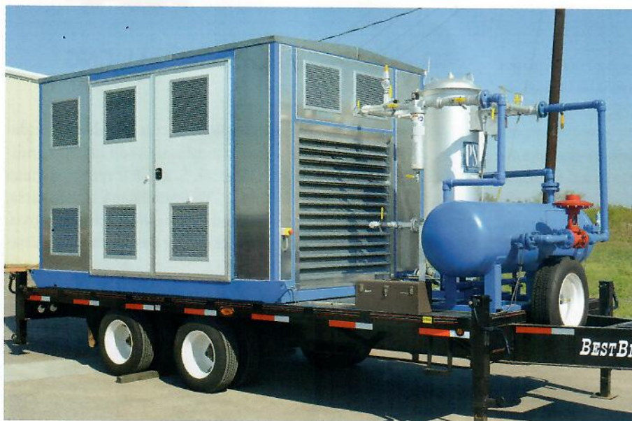
Pārvietojama CNG uzpildes stacija
